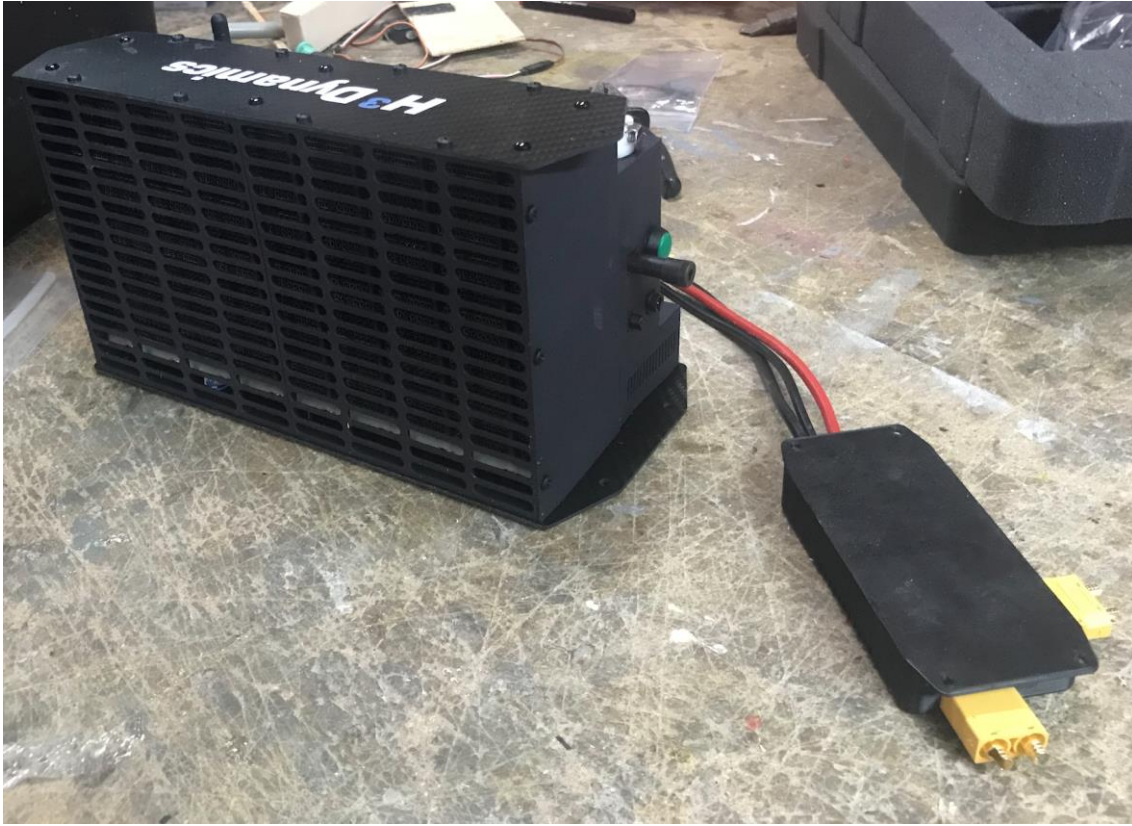
Célula de hidrógeno fabricada por H3 Dynamics de 1000 w de potencia
