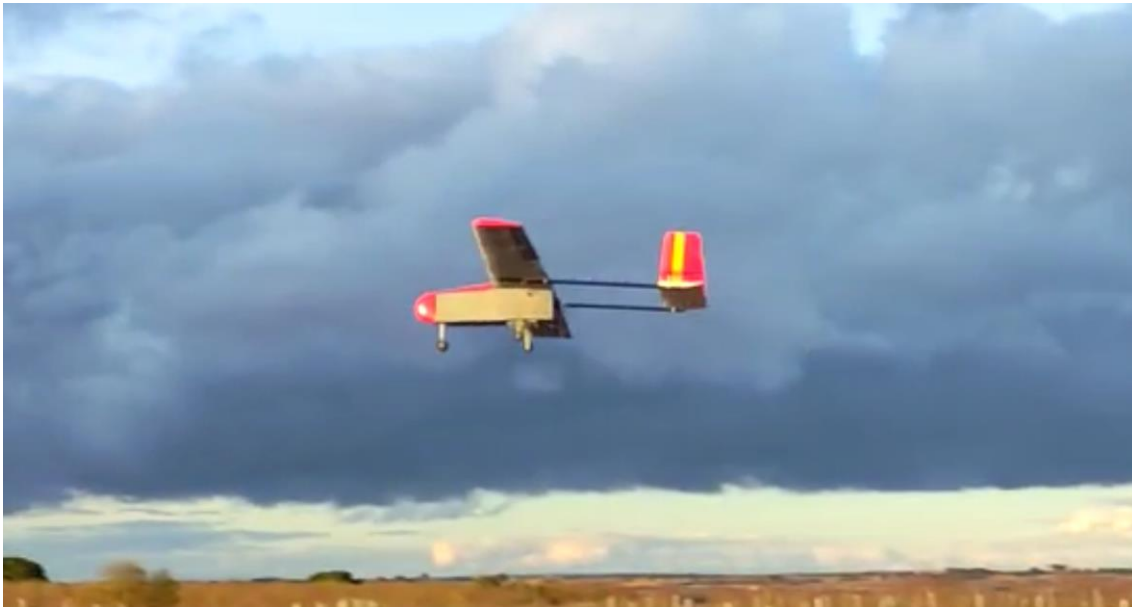
Primer vuelo con la célula de H2 instalada . 10 Dic 2022
