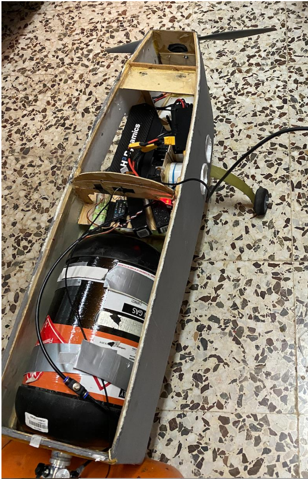
Disposición de célula y botella de hidrógeno en el fuselaje del UAV
